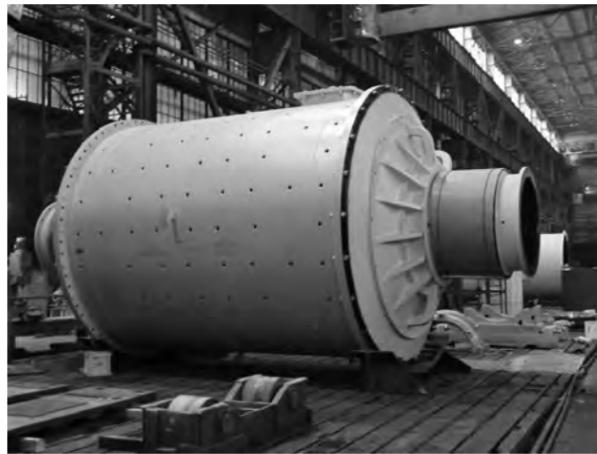
С учетом больших нагрузок в ее конструкции применены современные модернизированные сегментные подшипники, имеющие более высокую грузоподъемность и долговечность, чем однокорпусные, которые устанавливались в мельницах этого типа, выпускавшихся прежде.
