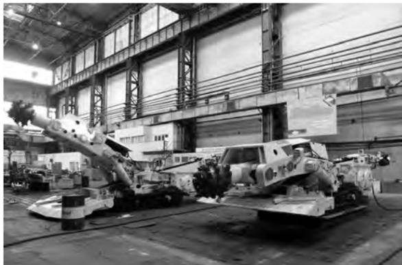
В отличие от проходческого комбайна серийной модели П110, который имеет две поперечные режущие коронки, новый П110-03 - с продольно-осевой режущей коронкой. Он был спроектирован и изготовлен дивизионом металлургического и шахтно-проходческого оборудования по просьбе шахтеров ЧАО «ДТЭК Павлоградуголь» специально для дешенских шахт, имеющих небольшие сечения выработки. Он меньших габаритов и может использоваться в выработках сечением 7-25 м<sup>2</sup>.
