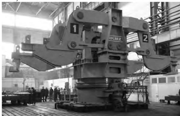
Данный стенд имеет два независимых подъема, грузоподъемность каждой лаги около 200 т. Но уникальность этого стенда по сравнению с другими, изготовленными на НКМЗ, прежде всего в том, что он - мобильный. Стенд устанавливается на имеющийся собственный привод выкатной платформы, которая будет передвигать его на пять метров от оси разлива.
