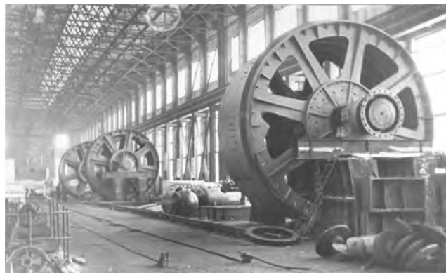
Сборка однобарабанных подъемных машин (1953 год)
