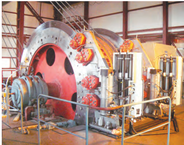
Шахтная подъемная машина МПМН 4×4-ТД с дисковыми тормозами, 2011 год. «ПО Беларуськалий», г. Солигорск, Республика Беларусь
