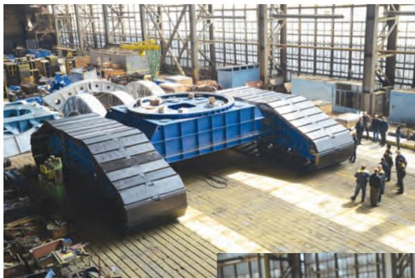
маторцами для данной машины. Первый узел – перегрузочная тележка, с помощью которой производится перегрузка горной породы с отвального конвейера непосредственно на конвейер отвалообразователя, был отправлен узбекским горнякам в начале апреля. Сегодня механосборочный цех №8 приступил к сборке следующего узла отвалообразователя – поворотной платформы, за которой последует поузловая сборка элементов системы консолей. Поворотная платформа устанавливается на гусеничную тележку, а уже на по-
