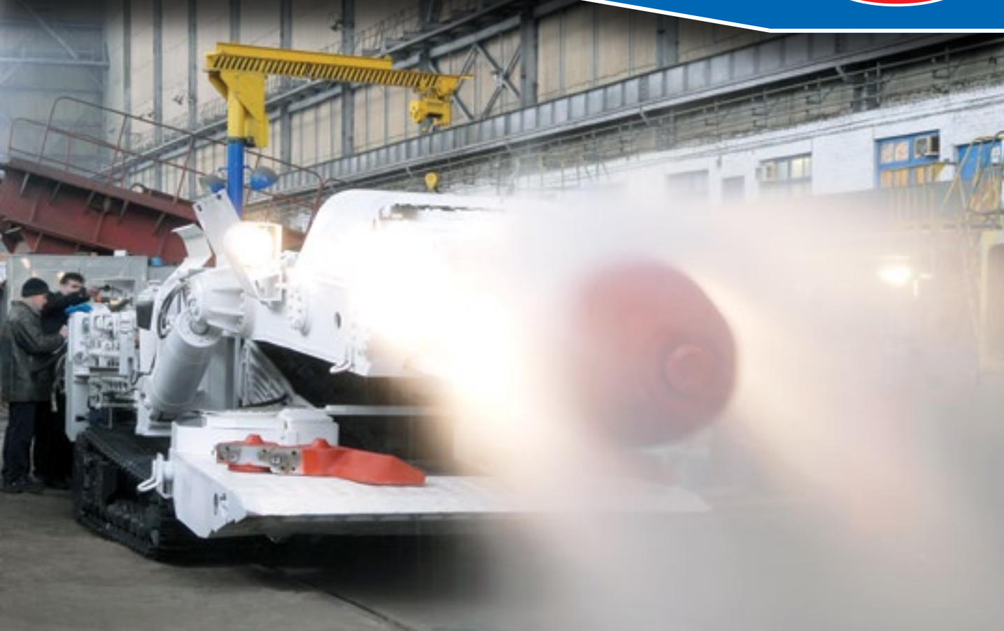
Испытание оросительной системы проходческого комбайна П110-04 Testing of irrigation system of the П110-04 roadheader
