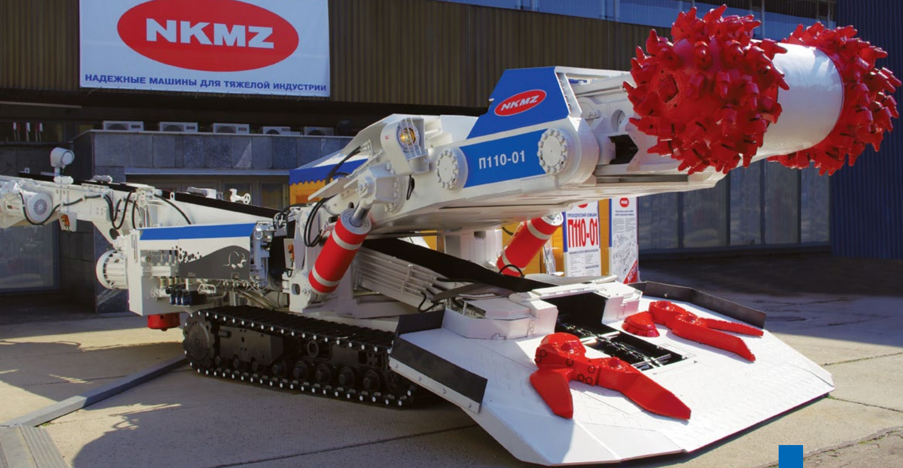
Проходческий комбайн П110-01 Roadheader П110-01
