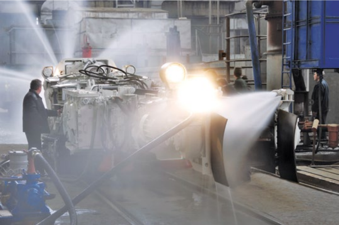
Испытание оросительной системы проходческого комбайна П110-04 Testing of irrigation system of the П110-04 roadheader
