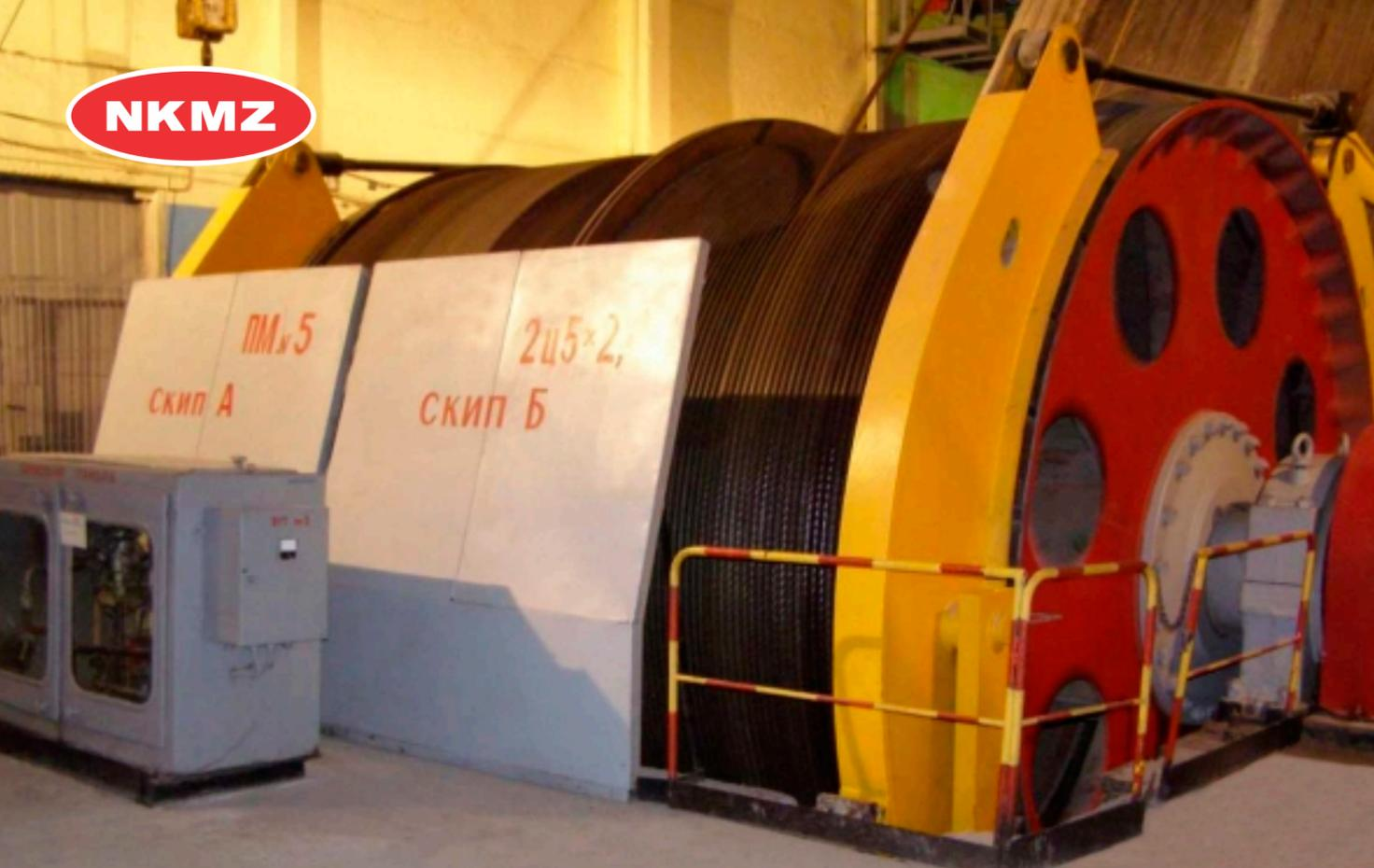
**МАШИНЫ ПОДЪЕМНЫЕ ШАХТНЫЕ ДВУХБАРАБАННЫЕ**
