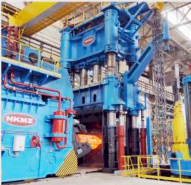
Кузнечно-прессовое производство обеспечивает выпуск поковок массой от 0,2 до 110 тонн из кузнечных слитков от 3,5 до 170 т. Процесс свободной ковки происходит на автоматизированных ковочных комплексах в технологической взаимосвязи с нагревательным, термическим и подъемно-транспортным оборудованием под управлением автоматизированных систем (АСУ ТП).
