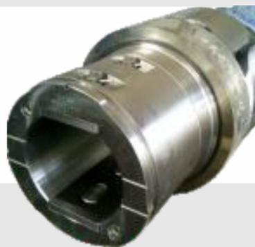
Валковая муфта карданного шпинделя сортового стана
