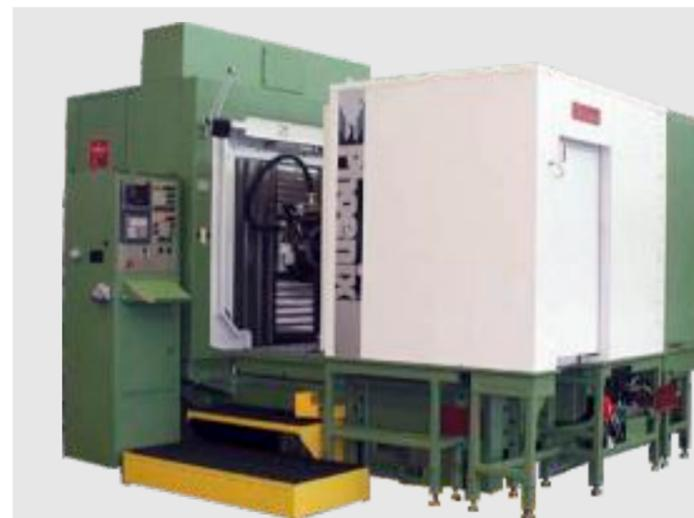
Типы нарезаемых зубьев – прямозубые и криволинейные (зацепление с круговым зубом, цикло-паллоидное зацепление, зацепление "Gleason").
