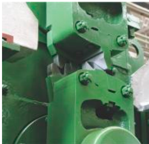
Установка на суппортах ножиц профильных ножей. Shaping knives installation on shears slides.
