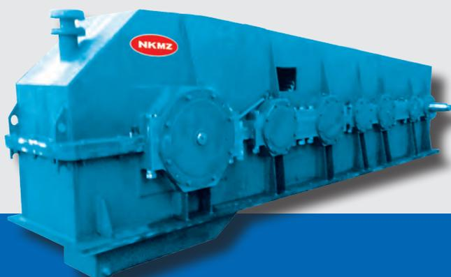
Редуктор главного подъема крана мостового электрического литейного КМЭЛ г.п. 470+100/20т
