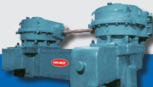
Редуктор привода установки верхнего вала клетки трио
