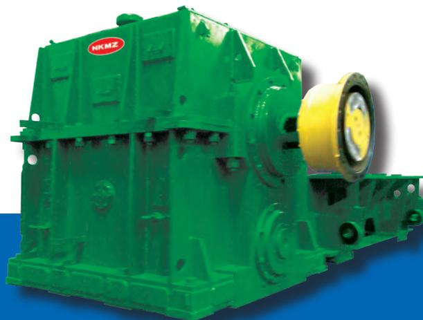
Редуктор привода моталки гидравлической стана 2500 г.п.
