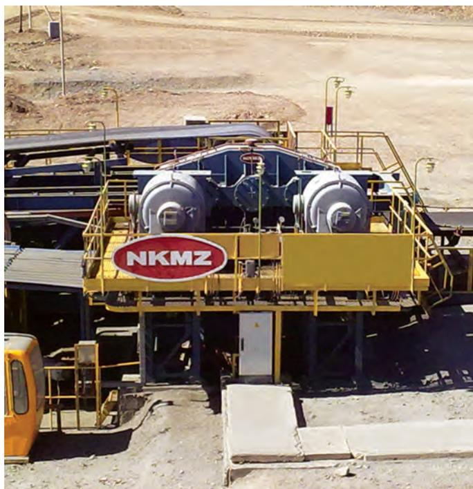
Редуктор приводной станции крутонаклонного конвейера
