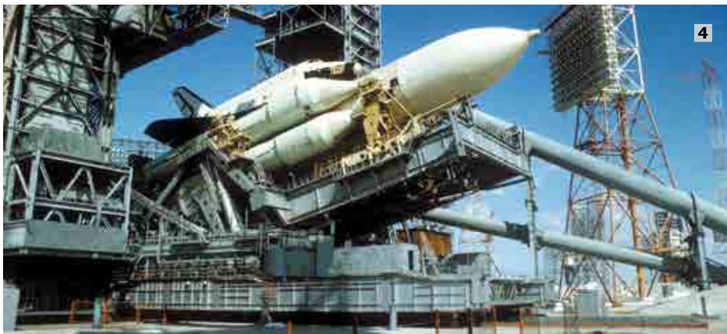
4 Транспортно-установочный агрегат 17Т12 ракетно-космического комплекса «Энергия-Буран». 17Т12 Transportation and installation unit of «Energia-Buran» rocket and space complex.
