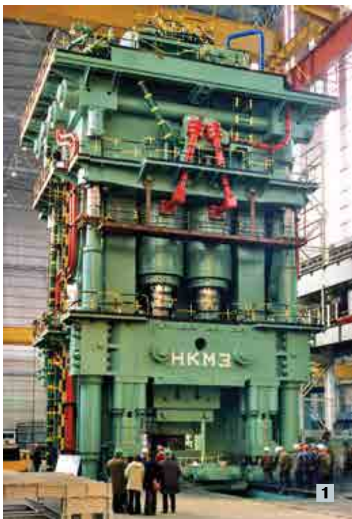
1 Гидравлический штамповочный пресс усилием 650 МН. Closed-die forging press with the capacity of 650MN.
