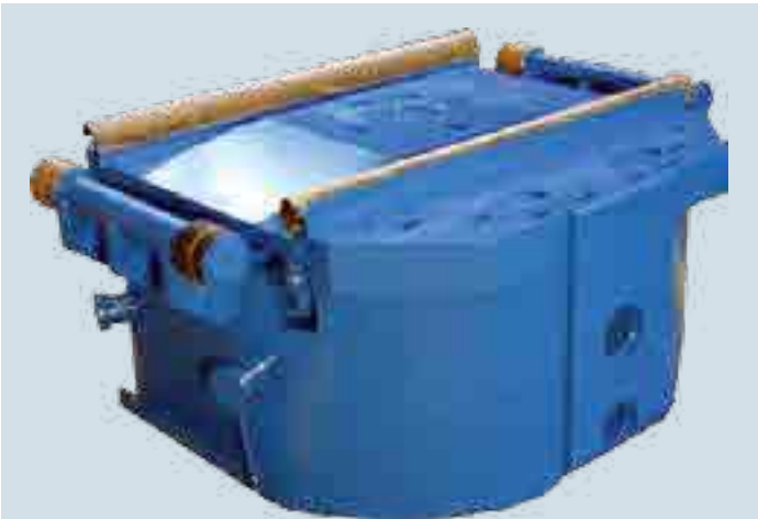
P_{клетей} = 9000 тс, ТЛС 5000 «Северсталь» P_{stand} = 9000 tf, 5000-mm plate mill «Severstal»
