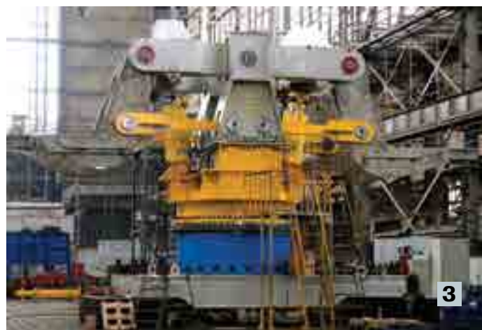
5 Железнодорожный кран 7Ж72 грузоподъемностью 80 т. 7Ж72 Railway crane with the capacity of 80 t.
