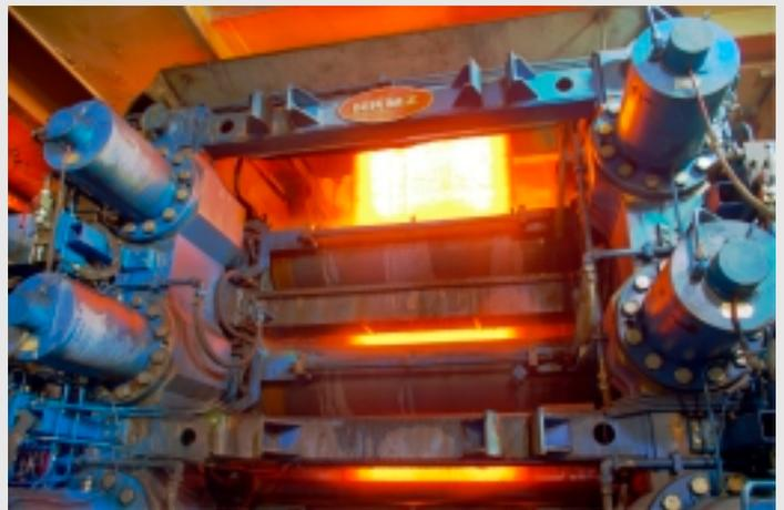
Диаметр роликов МНЛЗ от 150 мм до 500 мм
