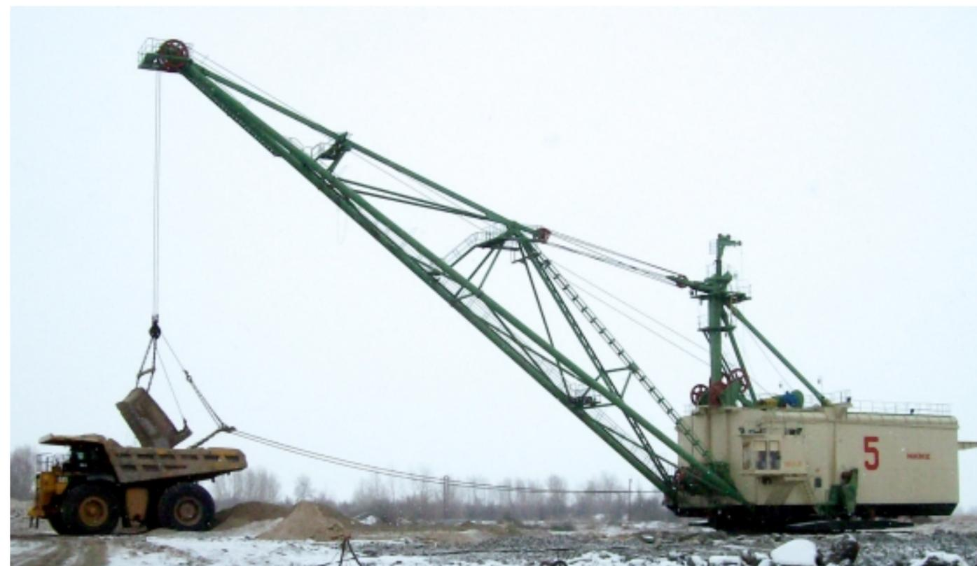
Погрузка экскаватором ЭШ-14-50-У в самосвал
