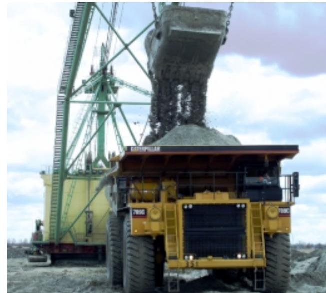
Для увеличения высоты отработанного уступа на карьерах при транспортной схеме разработки, НКМЗ предлагает новый вид экскаватора – шагающий драглайн погрузочного типа, который используется для разработки высоких уступов с погрузкой как рыхлых так и взорванных скальных пород в средства карьерного транспорта.
