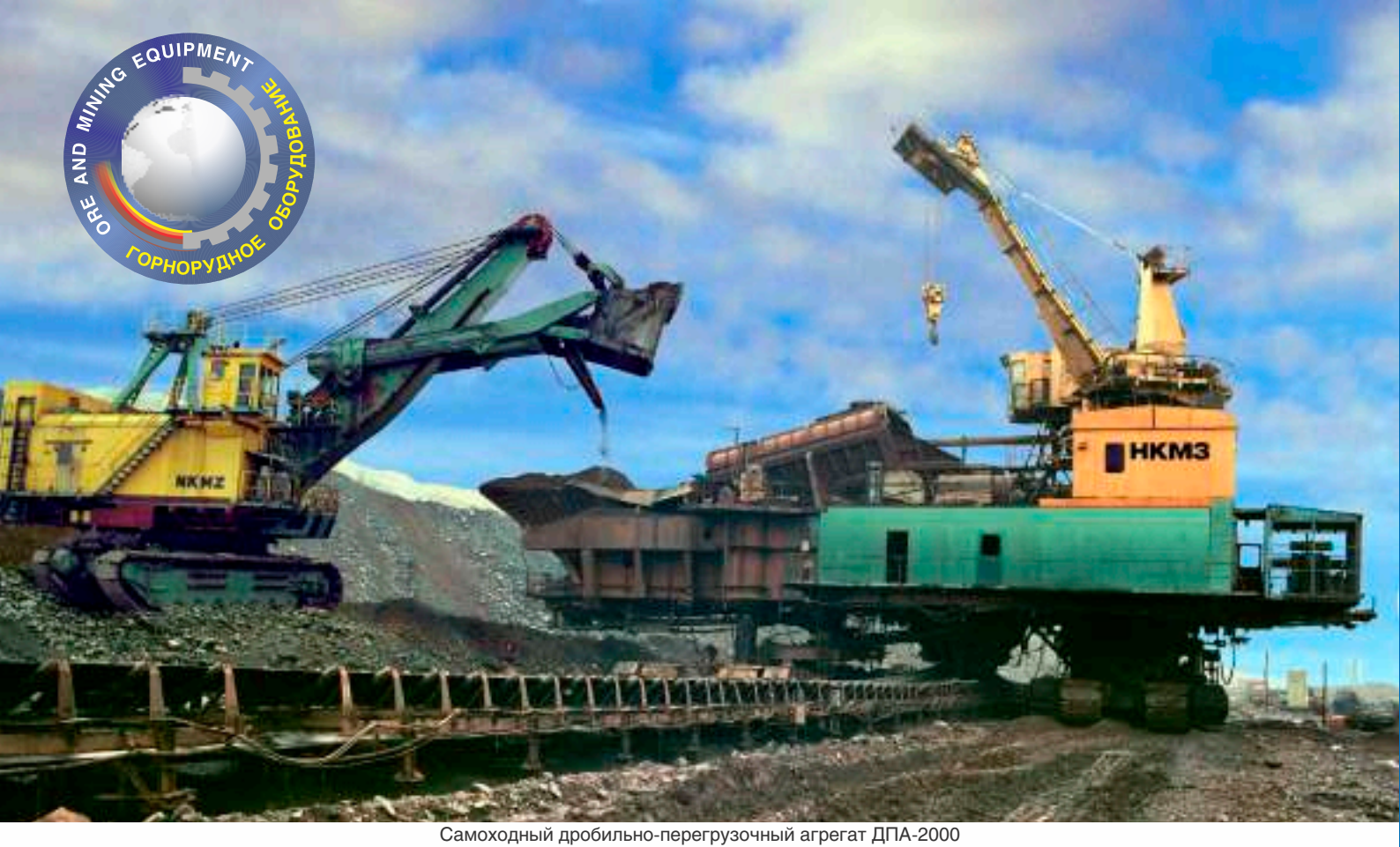
Самоходный дробильно-перегрузочный агрегат ДПА-2000 Дпа-2000 Self Propelled Crushing and Reloading Unit
