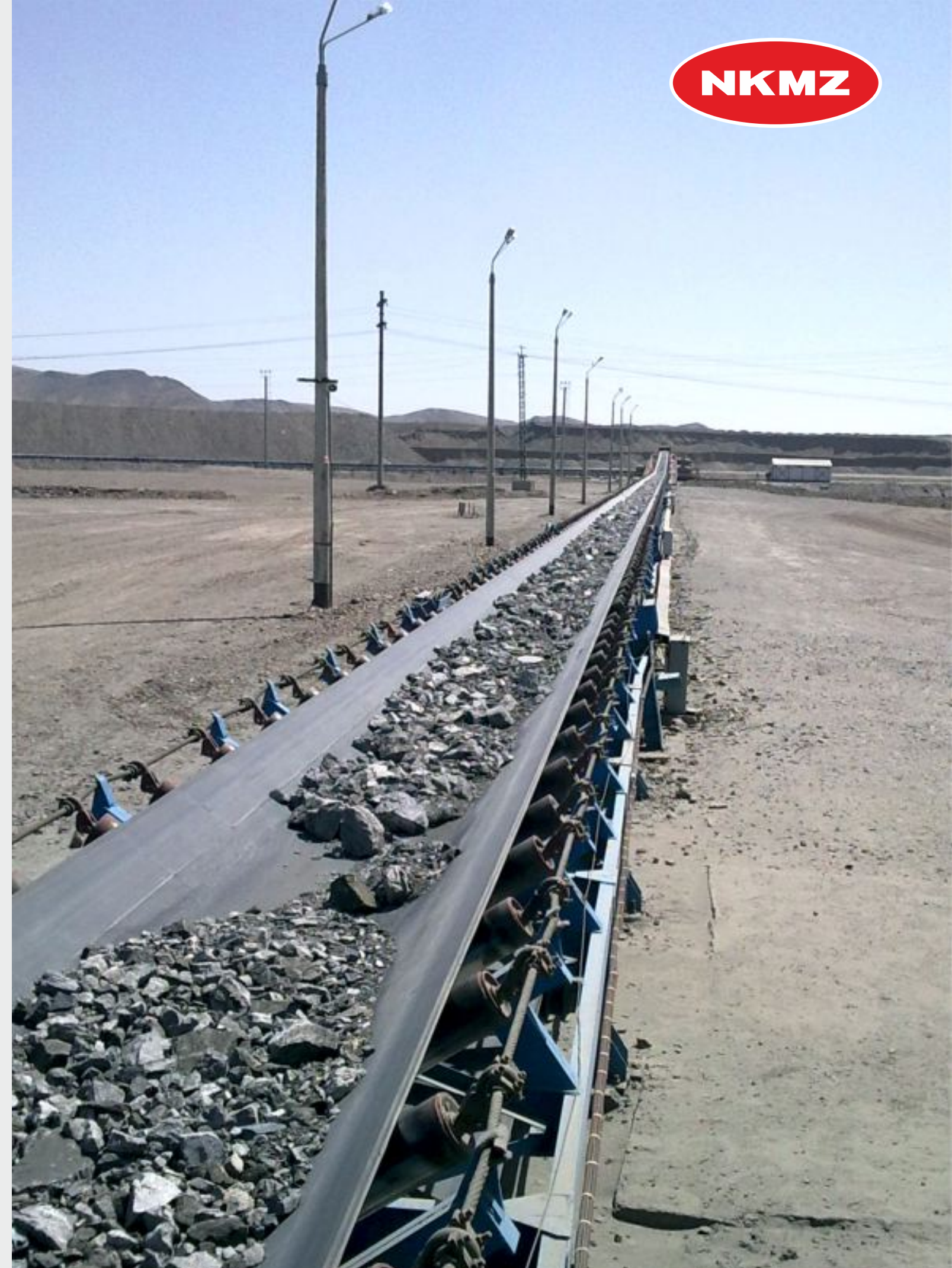
Линейная часть крутонаклонного конвейера High angle conveyor linear portion
