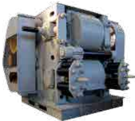
Дробилка четырехвалковая Д4Г-900x700 Д4Г-900x700 Four-Roll Crusher
