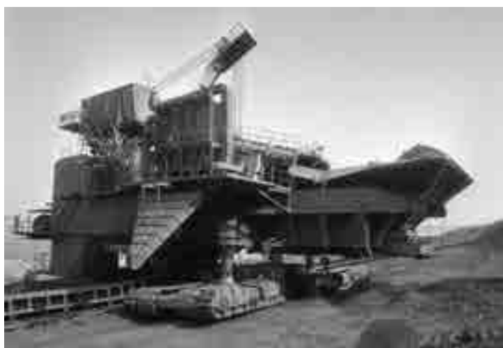
Самоходный дробильно-перегрузочный агрегат ДПА-2000 ДПА-2000 Self-Propelled Crusher and Transfer Plant
