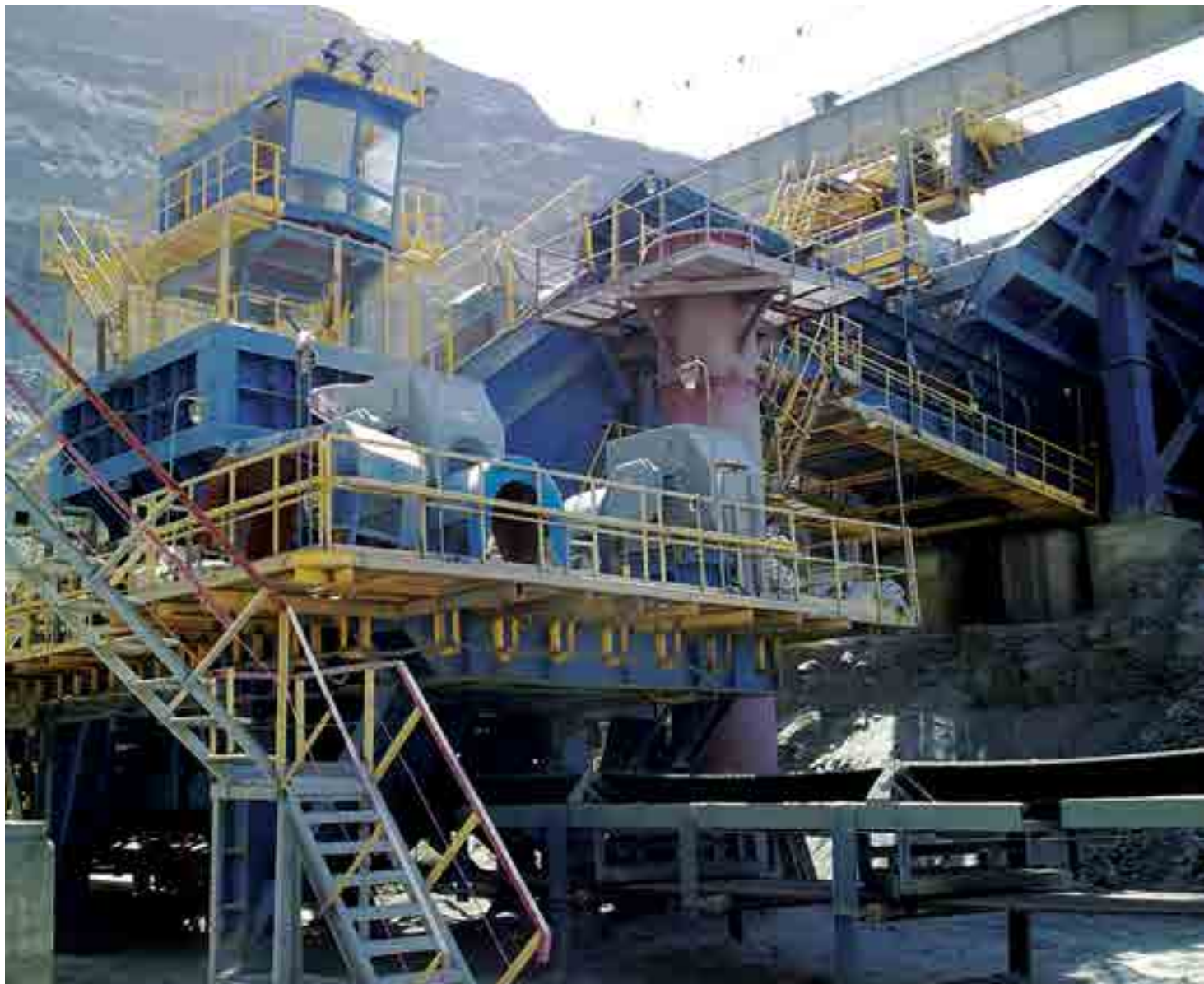
Дробильно-перегрузочная установка ДПУ-2000/3500 ДПУ 2000/3500 Crusher and Transfer Unit
