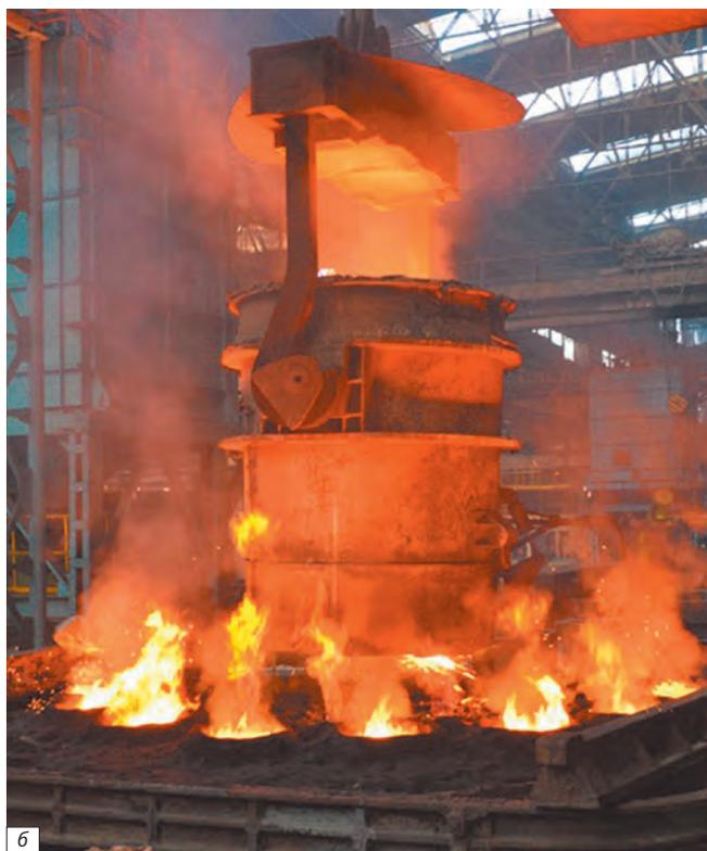
**Рис. 4.** Заливка: а — кузнечных слитков сифонным способом; б — отливки массой 140 т
