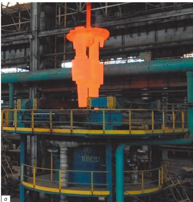
Рис. 9. Вертикальные (а) и шахтные (б) закалочные печи
