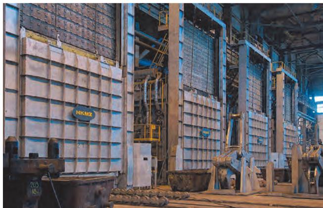
Рис. 8. Нагревательные и термические печи с выкатным подом
