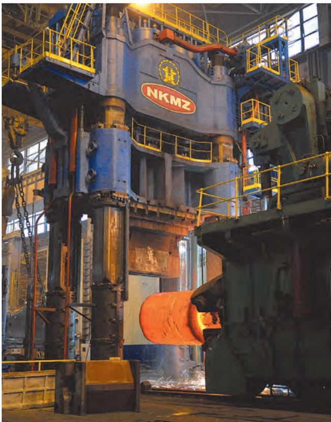
Рис. 7. Реконструированный автоматизированный ковочный комплекс АКК 12500/120 (2019 г.)
