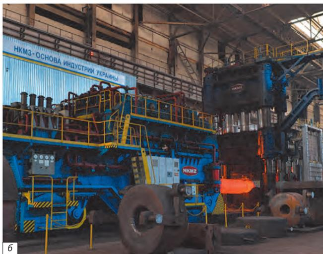
Рис. 6. Автоматизированные ковочные комплексы: а — АКК 3000/30 (2012 г.); б — АКК 5000/70 (2010 г.)
