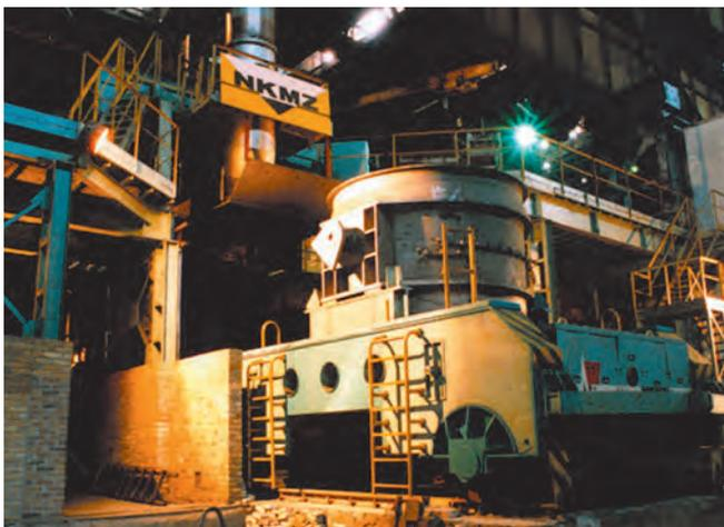
**Рис. 2.** Установки внепечной обработки стали «ковш-печь»: УКП-1 (1997 г.), УКП-2 (2009 г.)
