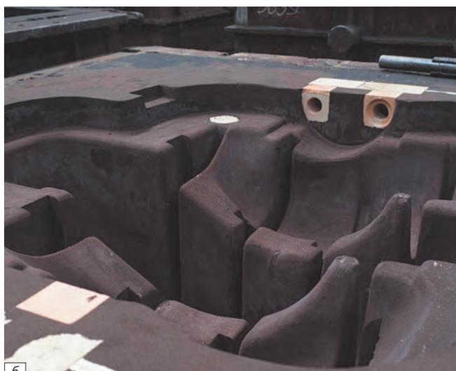
Рис. 12. Формообразование по «фуран-процессу»: а — в стержневых ящиках с помощью смесителя «FAT», б — в кессоне
